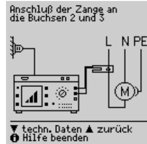
Mit einem an die Buchsen N (2) und L (3) angeschlossenen Zangenstrom-/Spannungswandler z.B. WZ12C können in zwei Messbereichen (1 mA ... 10 A ~, 1 A ... 100 A~) Wechselströme gemessen werden.
