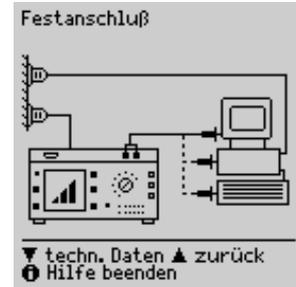
an Prüfdose des Prüfgeräts
