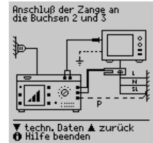
Die Potentialleitung muss in der Verteilung an den abgehenden Schutzleiter angeschlossen werden.
